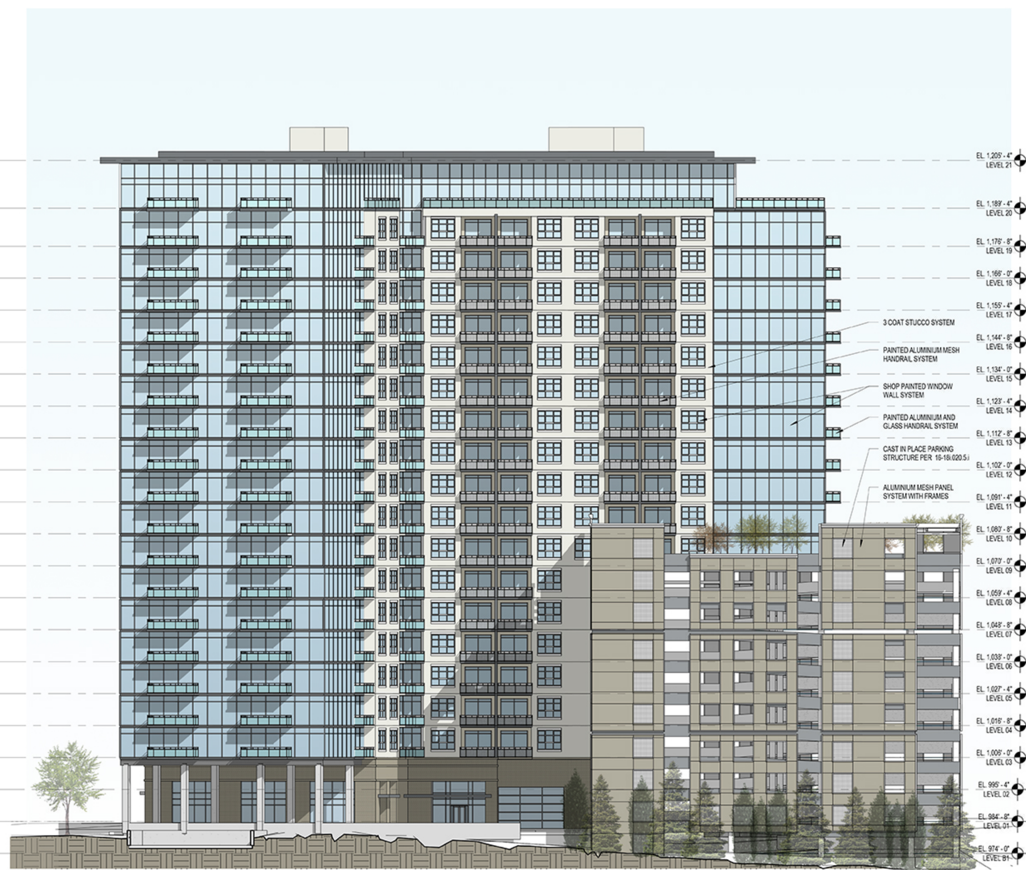
2 SOUTH ELEVATION Z4.01 SCALE: 1" = 20'-0"
